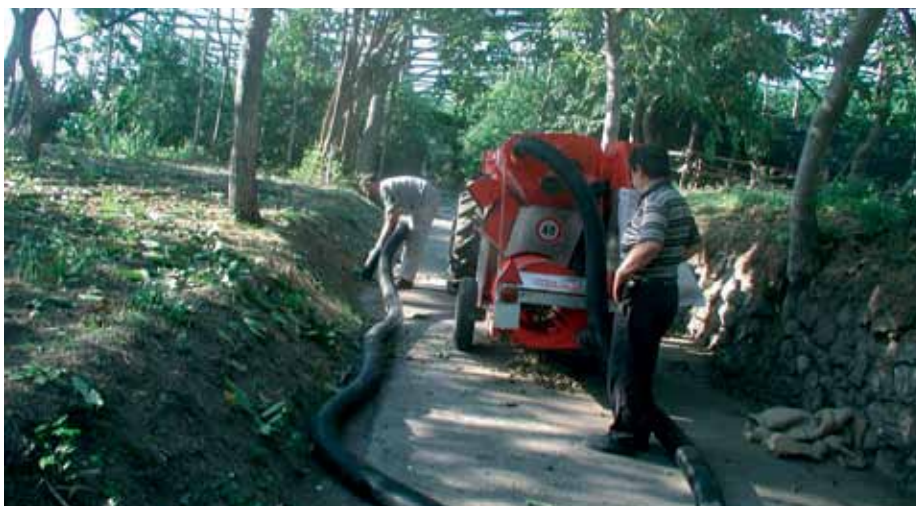
▲ Fig. 7 - Prova dimostrativa di raccolta a terra con macchina aspiratrice a tubo flessibile.
