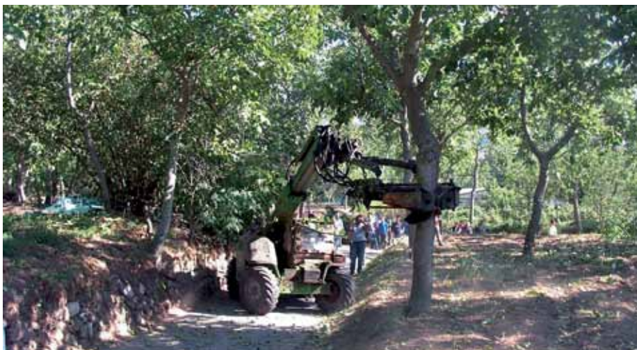
▲ Fig. 6 - Prova dimostrativa di raccolta mediante macchina vibratrice al tronco (foto Pagano).
